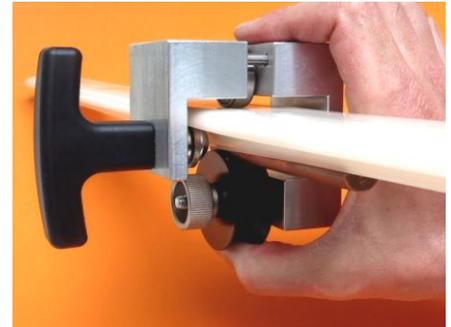
3) Führungsrolle an die Unterseite des Fahrdrahtes drücken und dann mittels Rändelmutter die Distanz fixieren. Vorteil: So kann den verschiedenen Fahrdrahtquerschnitten oder teilabgenutzten Fahrdrähten Rechnung getragen werden.
