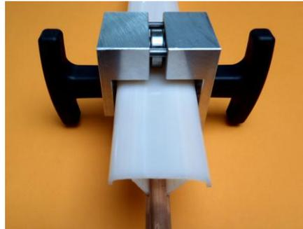
2) Profil zusammen mit dem Werkzeug auf den Fahrdraht setzen. Für das Festhalten des Profils ist eine zweite Person erforderlich.
