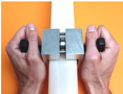
4) Das Werkzeug horizontal zu den Fahrdrahtkerben über das Profil hinwegstossen.
