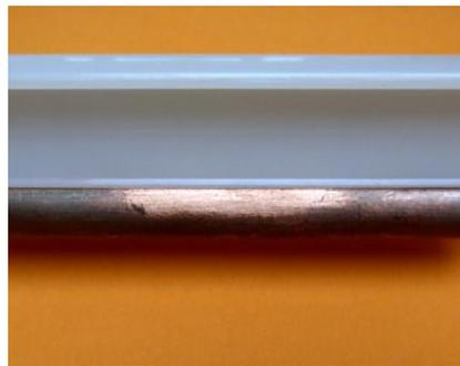
5) Kontrollieren, ob das Profil überall fix mit der Kerbe im Fahrdraht verbunden ist.
