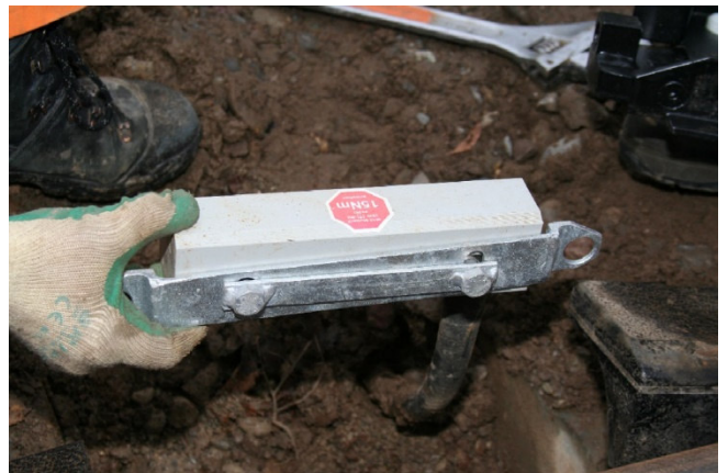
Achszähler/Radsensor an Halterung.
