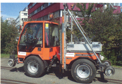
Selbstfahrendes 2-Wege-Fahrzeug Schmalspur Linth
