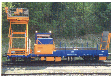
Selbstfahrender Bahnwagen Reuss mit 6m-Scherenbühne
