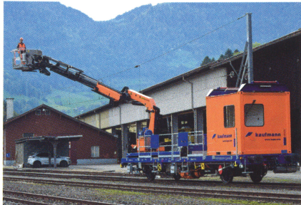
Selbstfahrender Bahnwagen Rhein mit 18m-Kranmodul/Arbeitsbühne Stoos
