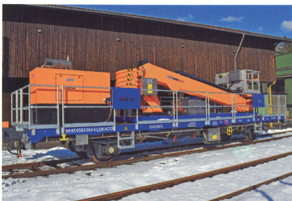
Twistlock Flachwagen Saane mit 18m-Teleskophebebühne Matterhorn
