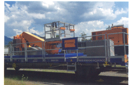
Twistlock Flachwagen Limmat mit 14m-Teleskophebebühne Mythen
