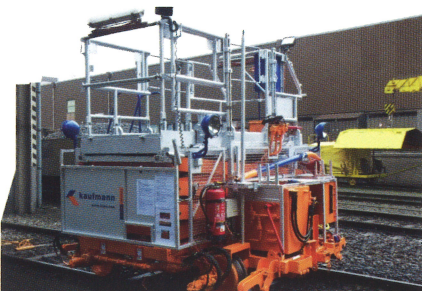
Selbstfahrende 6m-Scherenbühne Schmal- und Normalspur Sihl
