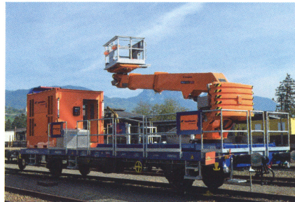
Selbstfahrender Bahnwagen Rhone mit 14m-Teleskophebebühne Fronalpostock
