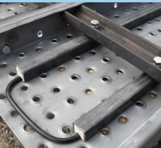
Patentiertes Heizsystem an der Unterseite
